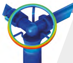
Aucun effet couronne détecté, comme prévu par la simulation de l'effet de couronne.
