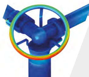
Efecto corona no detectado tal como refleja la simulación de efecto corona realizada.
